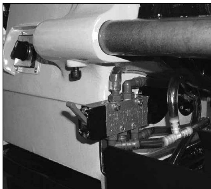
Fig. 9: Umschaltventil für Linksgewinde Fig. 9: Switch valve for left-handed threads
