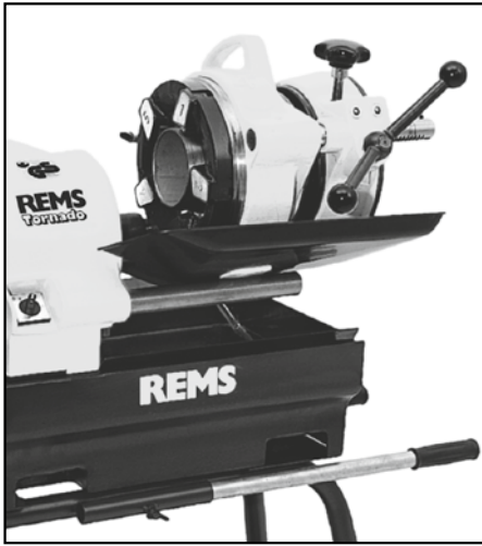
Fig. 6: REMS 4" Automatik-Schneidkopf auf REMS Tornado Fig. 6: REMS 4" automatic die head on REMS Tornado
